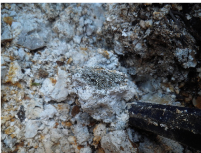
写真7 露頭鉱脈中あった鉱石。粘土化した母岩中に黄鉄鉱の微晶がかたまっている。写真だけ採集。
