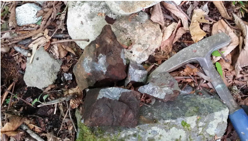
写真 10 方鉛鉱豊富な塊。ハンマーで割ってできた劈開面は銀光り。
